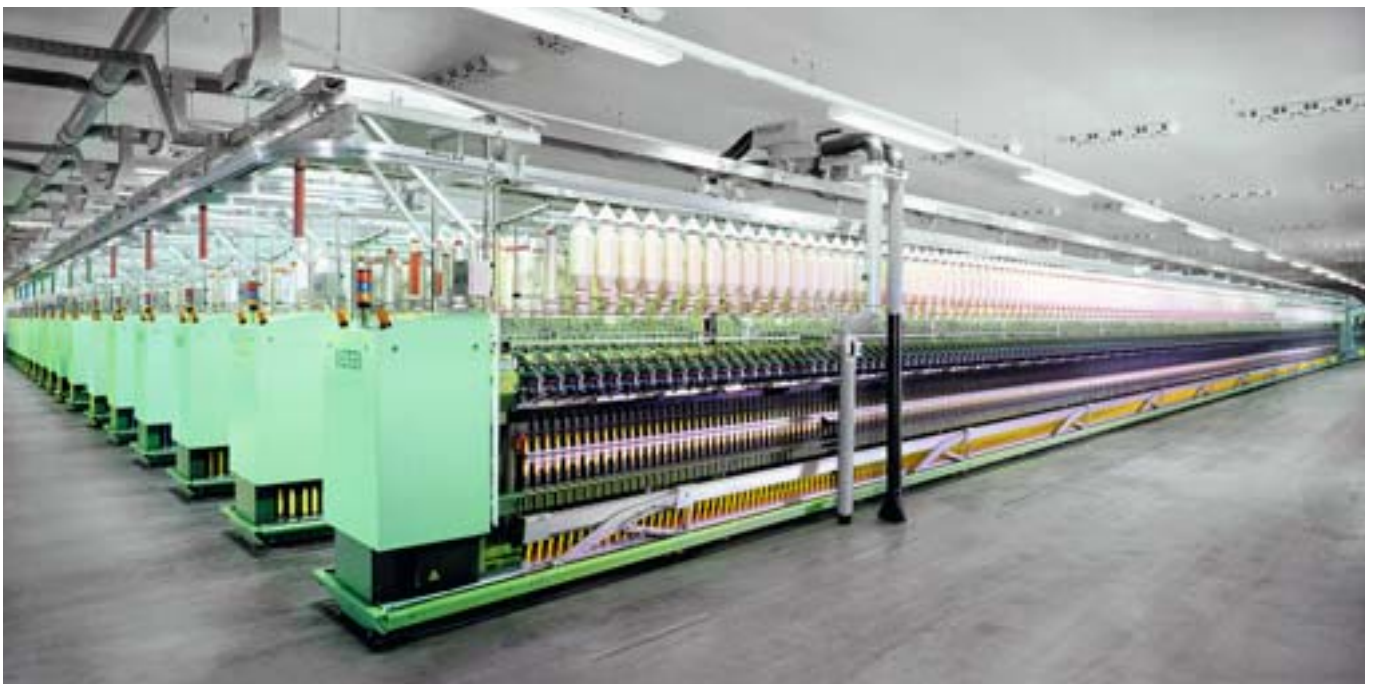
Wanderreiniger UNICLEAN über einer Spinnmaschine • Travelling Cleaner UNICLEAN over Spinning Frame
