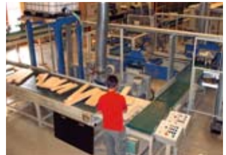
Optimierungskappanlage und Keilzinkenstraße
