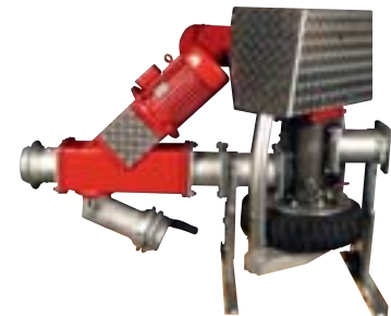
Balgpumpe mit vorgeschaltetem Rohrhäcksler
