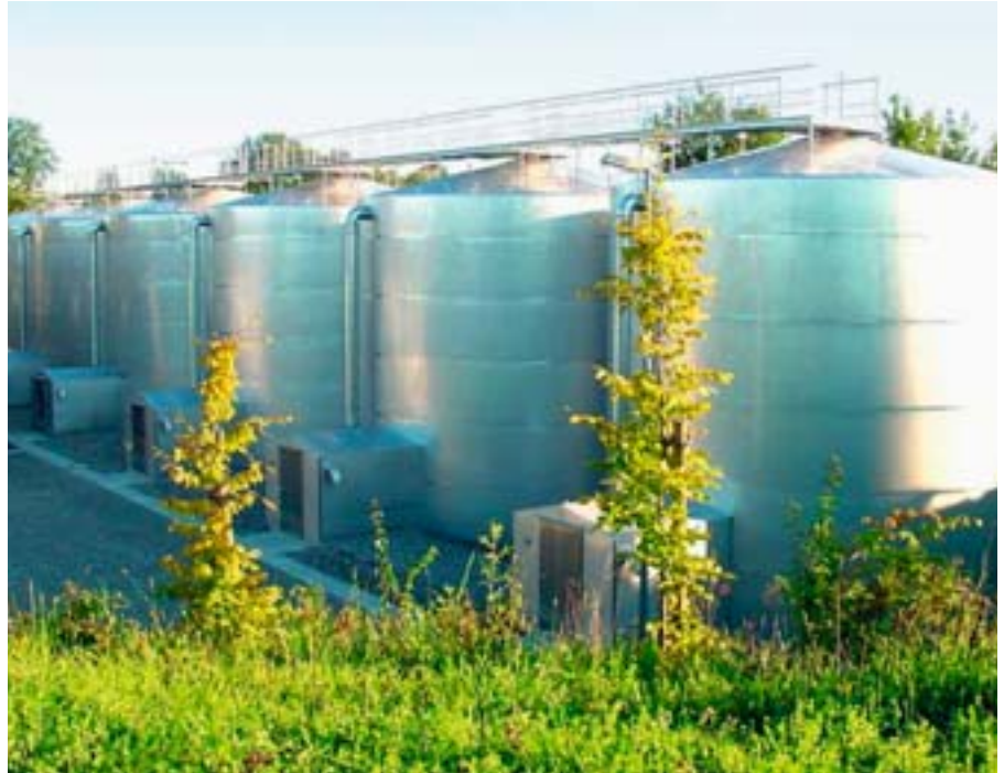
Montagegeschweißte Mineralwassertanks bei einem regionalen Getränkeproduzenten
