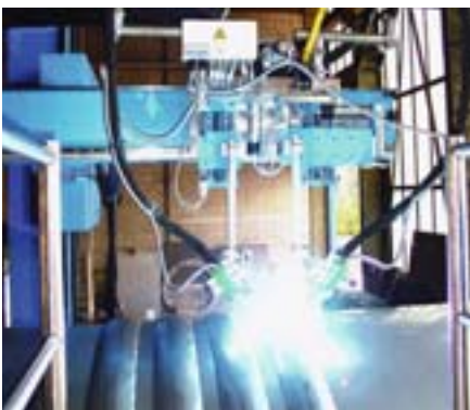
Automatisierte Profilier- und Schweißanlage für Kühlprofile
