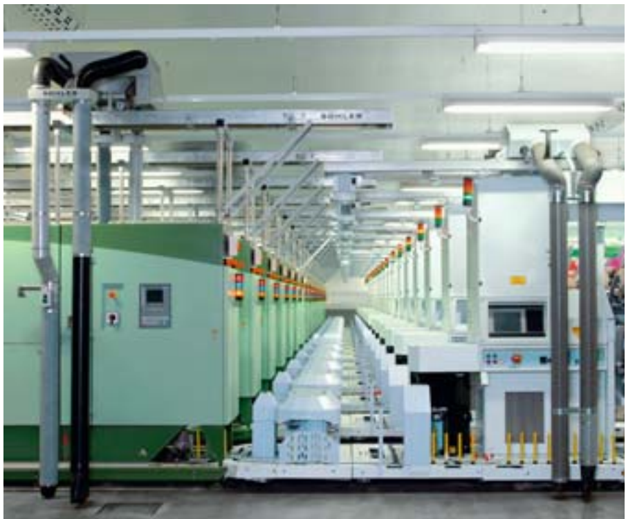
Wanderreiniger UNICLEAN über einer Spinnmaschine sowie Wanderreiniger TEXPRO über einer Spulmaschine Travelling Cleaner UNICLEAN over Spinning Frame as well as Travelling Cleaner TEXPRO over Winding Machine
