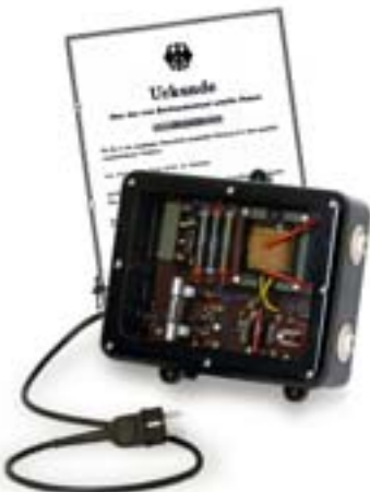
Weidezaun-Netzgerät AKO E1 von 1956; Kondensator-Prinzip, mit gasgefüllten Schaltrohren, 600 V mit Spartrafo 220/600 Volt.
